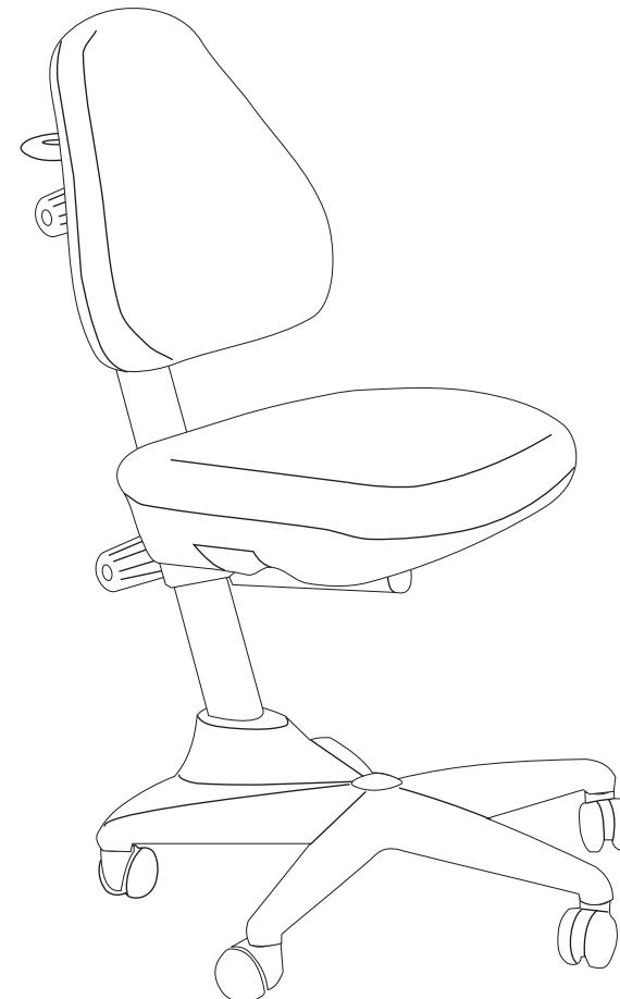
**Примечание:** При сборке кресла сначала следует выпрямить спинку относительно сиденья и только затем затянуть регулировочные винты
